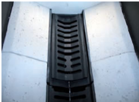
Подвижный колосник для удаления пепла
