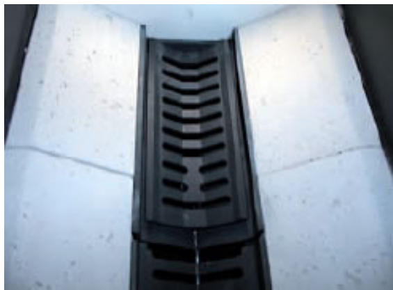
Подвижный колосник для удаления пепла
